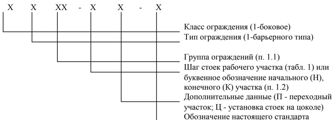
Пример условного обозначения марки ограждения бокового барьерного типа дорожного одностороннего с шагом стоек 3 м:
